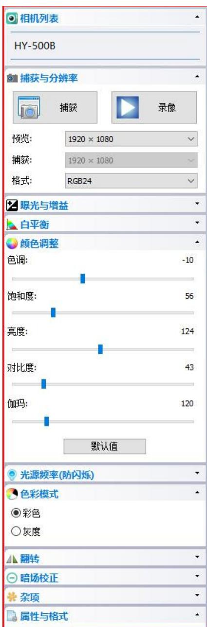
相机设备设置：可选择不同类型的相机、预览分辨率以及图像的输出格式。
